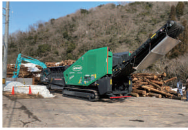
補助金採択によって導入したチップー (原木を破砕し、木質チップにするために 必要な重機)
